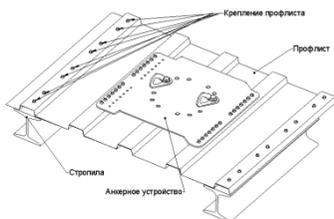
Для установки анкерного устройства на профлист используется 28 кровельных саморезов с шайбой (размер min/ 4,9x19). Саморезы должны быть плотно вкручены в посадочные отверстия в точке, но без срыва резьбы.
